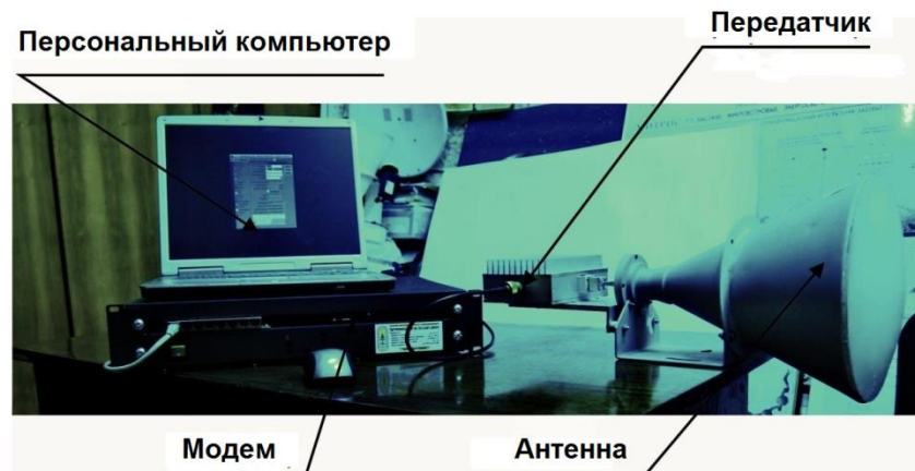
Рисунок 5 - Внешний вид лабораторного образца цифровой симплексной радиорелейной системы терагерцового диапазона
