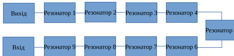
Структурна схема радіочастотного смугового фільтра “ФС-1920-2-30”
