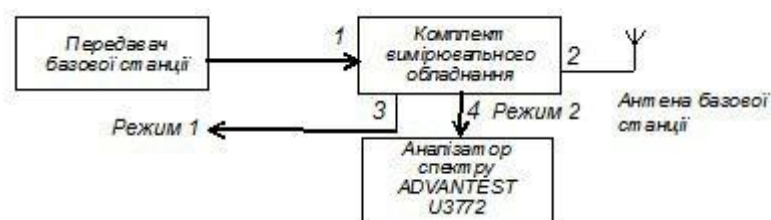
Рисунок 1. - Схема підключення обладнання до базової станції
