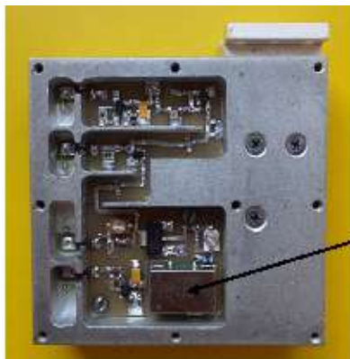
Рисунок 9 – Задавальний генератор, змонтований на зворотній стороні корпусу гетеродина
