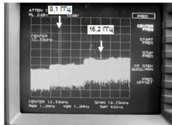
Рисунок 10 – Спектр сигналу гетеродина в області частоти 8,1 ГГц (розмах спектра на екрані 19 ГГц)
