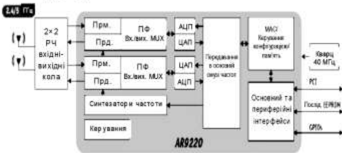
Рисунок 7 – Структурна схема ПЛІС AR9220
